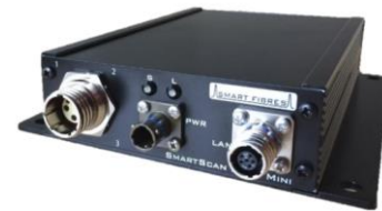
Fig. 1: SmartScan Aero mini interrogator
